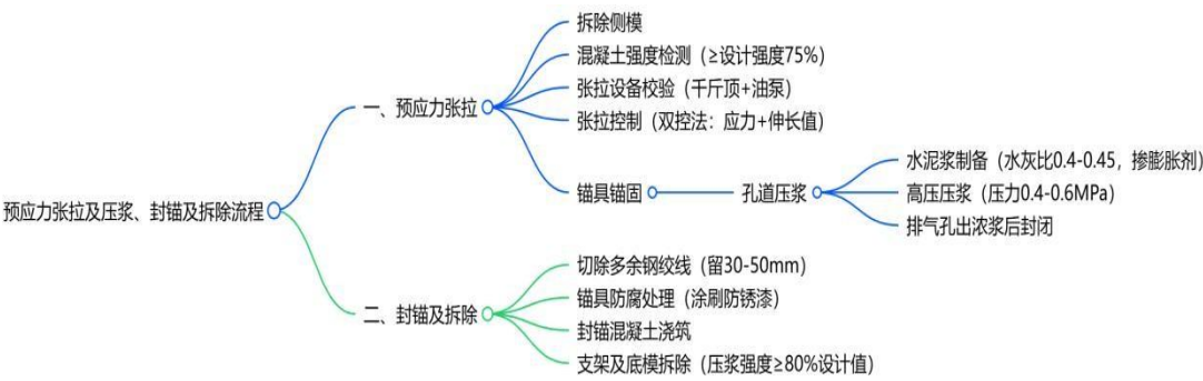
图 5.9 钢绞线施工工艺流程图
